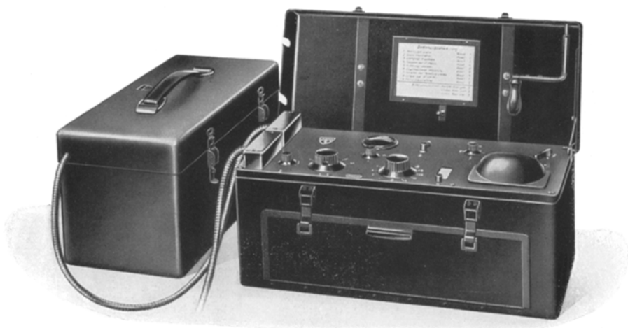
Abb. 1. Tragbarer Verstärker-Elektrokardiograph. Maßstab 1 : 10. Ein Kasten von 23 \times 54 \times 26 cm Größe enthält den Aufnahmeapparat, ein zweiter von den gleichen Abmessungen die Batterien, den Akkumulator, die Anschlußkabel und alles sonstige Zubehör. Die Gewichte der Kästen einschließlich Zubehör betragen 19 und 21 kg.
